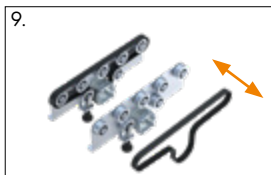
9. Seitenteil entfernen und Riemen tauschen
