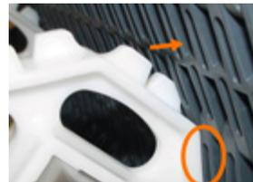
Prüfen Sie bei Flush Grid-Bändern den korrekten Zahnradengriff von der Bandoberfläche.
